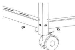
1º - Realizar a fixação dos quatro parafusos e porcas, fazendo com que a roda fique corretamente apertada na chapa.
