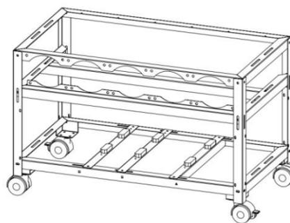
2º - Retirar as peças presas / fixadas na parte inferior dos pés do RIG. Feito isso, posicionar a chapa com a roda fixada no passo anterior, na parte interna do pé, juntamente com as peças retiradas da estrutura anteriormente e fixar/parafusar ambos à estrutura, conforme imagem a seguir.
